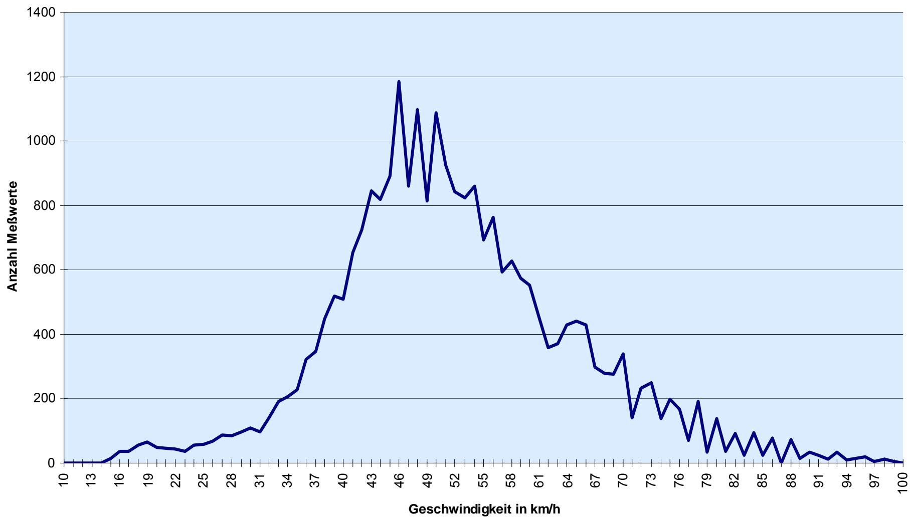
Die Histogramm-Darstellung der Geschwindigkeitsdaten bietet einen schnellen und lückenlosen Überblick über die Gesamtverteilung der gefahrenen Geschwindigkeiten.
